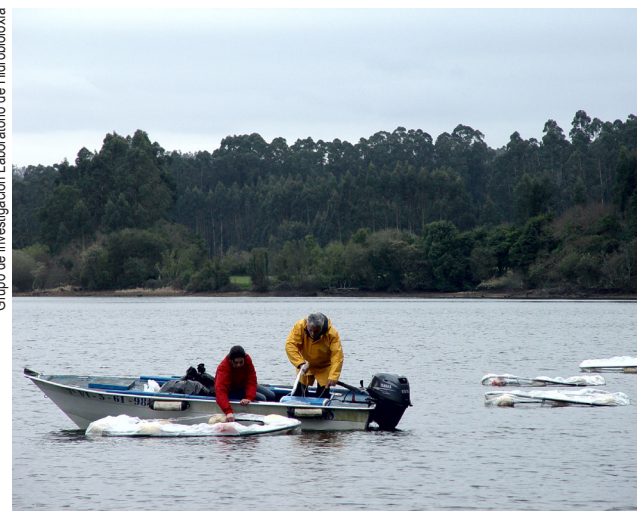
Instalación de limnocorrais para o estudo do control de cianobacterias.
