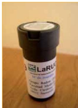
Medidor de gas radon.
