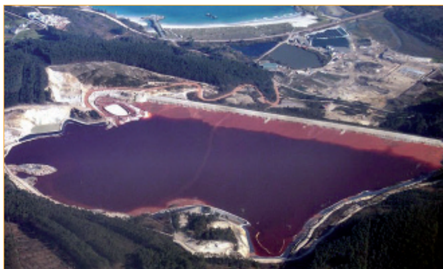
ALCOA produce 1.300.000 toneladas de lodos vermellos ao ano, que almacena nesta enorme balsa en San Cibrao.
