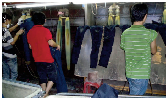
Traballadores pulverizando permanganato de potasio nunha fábrica de China.
