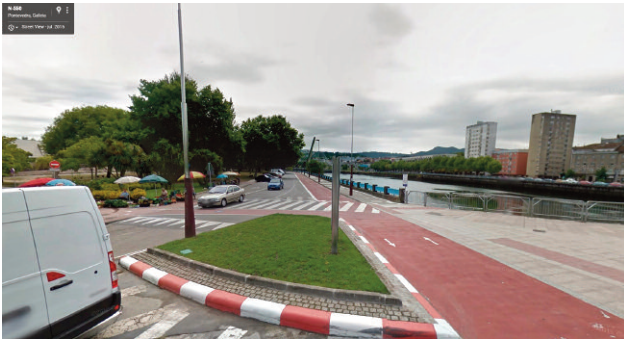
Fig. 3 Carril bici bidireccional en calzada sen protección (non recomendado no plan para Lugo). Pontevedra.
