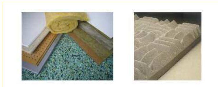
Figura 3. Fotografía dalguns exemplos de materiais absorbentes en forma de placas e mantas (esquerda) e con estrutura piramidal (dereita).
