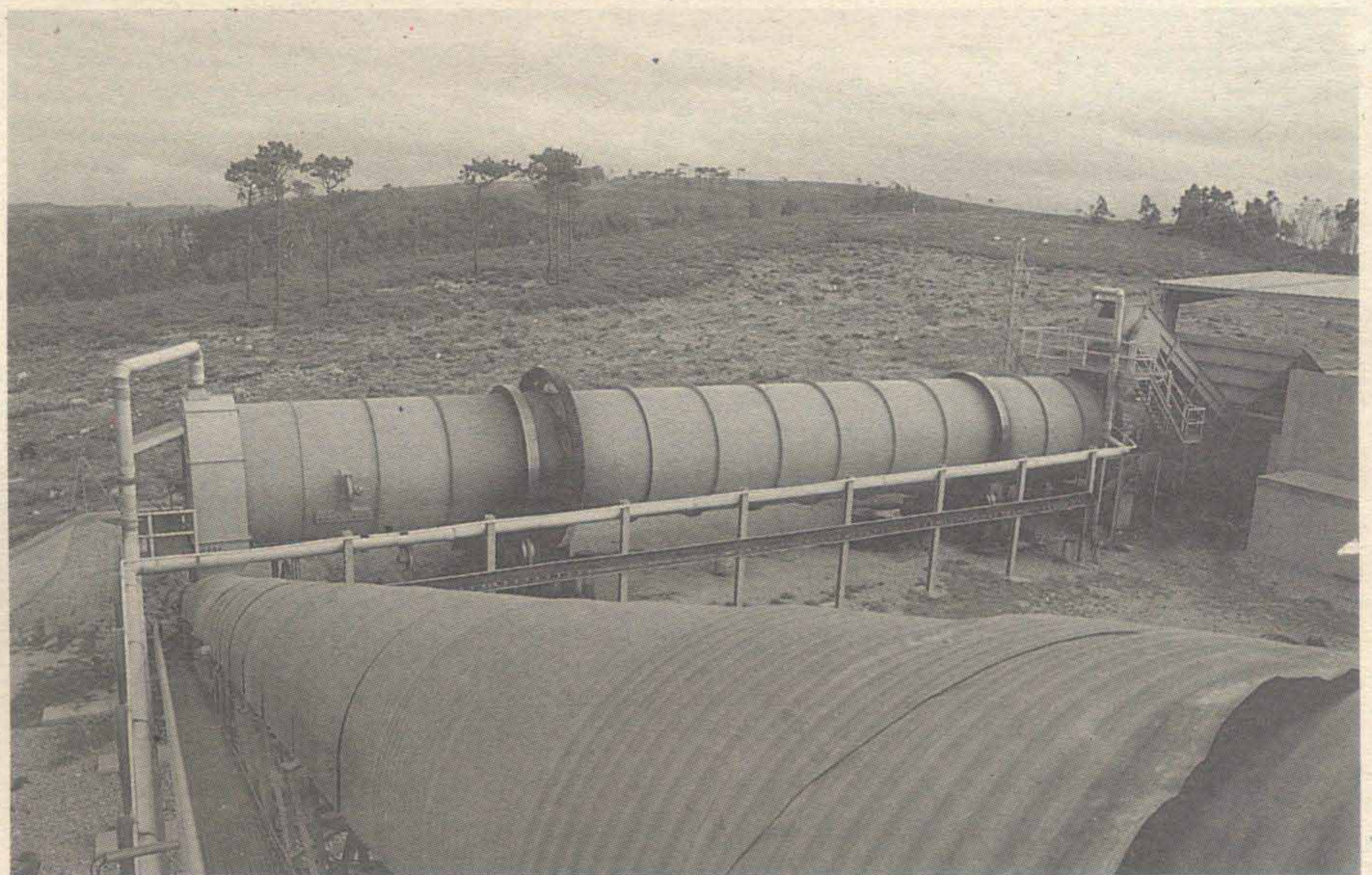
Planta de reciclaxe de Mougá. Con esta planta, algúns concellos da Mancomunidade de Ferrolterra están a aplicar un tratamento mixto, con recollida selectiva parcial, separación na propia planta, e obtención de compost, levando ao vertedeiro os rechazos.
