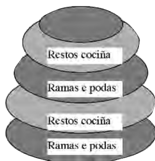
COLOCACIÓN DOS DIFERENTES MATERIAIS NA MOREA DE COMPOST
