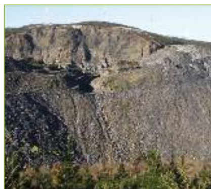
Burato de explotación e entulleira dunha explotación de pizarra en Ortigueira (A Coruña).
