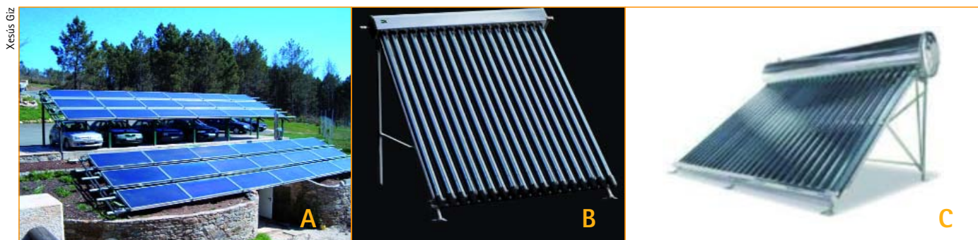
Outros tipos de paneis: A) Panel plano utilizado como marquesiña para aparcadoiro. B) Tubo heat-pipe con estrutura de soporte a 35° para disposición en cuberta plana. C) Colector heat-pipe compacto para vivenda unifamiliar con estrutura de soporte e depósito acumulador integrado.
