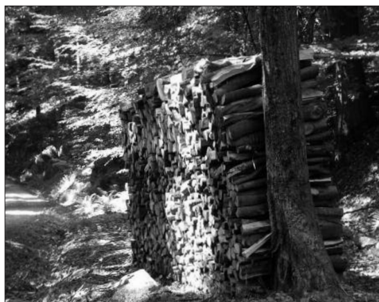
Figura 10. Secado ao aire libre (esquerda) e secado artificial (dereita).
