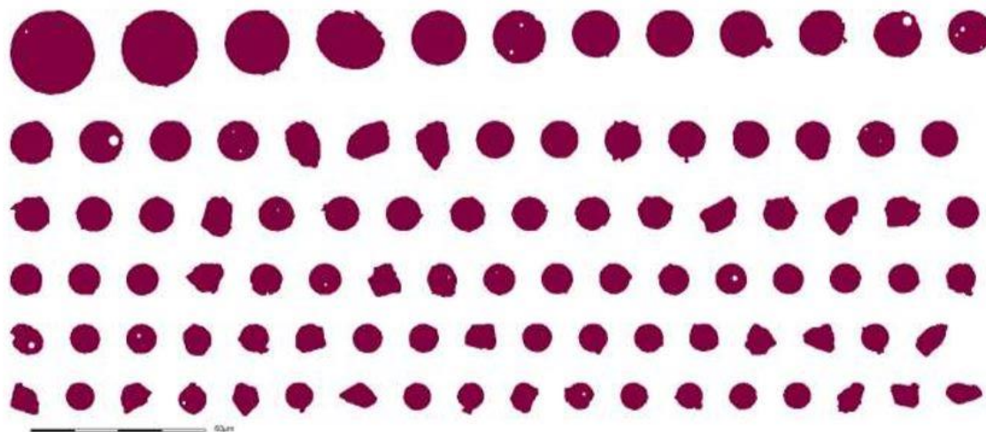
Figura 1 – Detalle de la muestra 22395 donde se observan partículas esféricas del supuesto abrasivo granatífero o con composición análoga a un granate.
